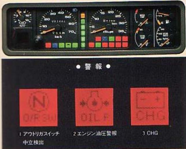
メータパネルに透過式照明を採用、無反射状態でメータを確認でき、見やすさを高めました。レイアウトも一体感があり、走行中の目の動きを最小限におさえることができます。さらには、ギヤポジション表示をハンドルの目の前に設置、ギヤチェンジの際でも視線を変えずにそのまま行えます。また、スピードオーバーや作動油温、燃料残量など17種におよぶ走行状態やメカニカルな状況を、液晶インジケーターで点灯表示。安全への願いをおしみなく導入しました。
