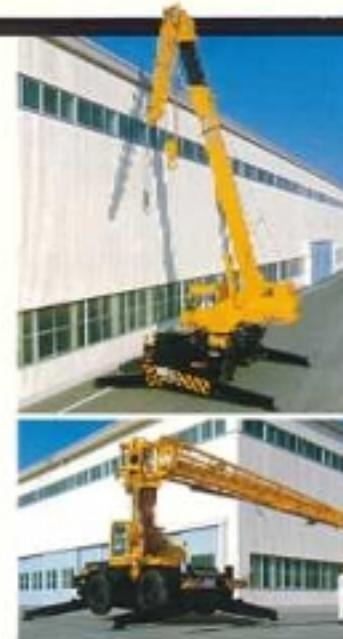
■2方式のジブ張り出ししが行える張り出し装置付横折り曲げ式ジブ。
