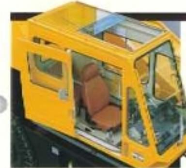
乗用車並のハイバック式リクライニングシート。出入りの便利なスライド式ドア。作業時の視界と通気性を充てるスライド式ルーフウインド(ワイパー付)。走行時、作業車の荷役台に上るキャブ構造の2つドア。フロントガラスの「U」型室内構造にテプロスター付フレームヒーター。さらに進行方向に向って作った引送れる操作柄など居住性、作業性をきめ細かに配慮しました。
