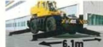
■作業性のよい大型アウトリガ。クラス最高の安定性。
