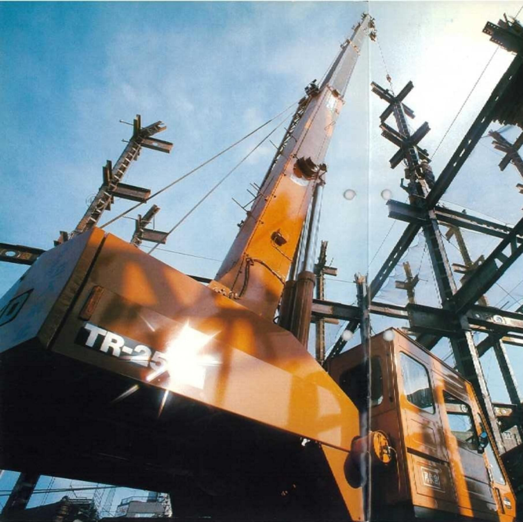
新型TR-250Miは、名実ともに日本を代表するラフターラインクレーンメーカー・タグノの強力な25t吊りです。25×3.5m×6.5×10mとクラス最高の吊り上げ性能を実現。26mブーム、12mの2段積新式2段引き出しジブいずれもクラス最長を誇り、最大地上揚程40.4mを実現。また作業能率のよい2モータ2ドラムのウインチ、作業性のよいX型アオリガ、コックアップ機構付トルクコンバーター、逆ステアリング補正機構付ステアリング。さらに最高走行速度49km/hなど高性能を満載。
