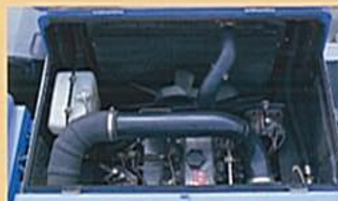
最高出力220PS/2,800rpmのエンジン
