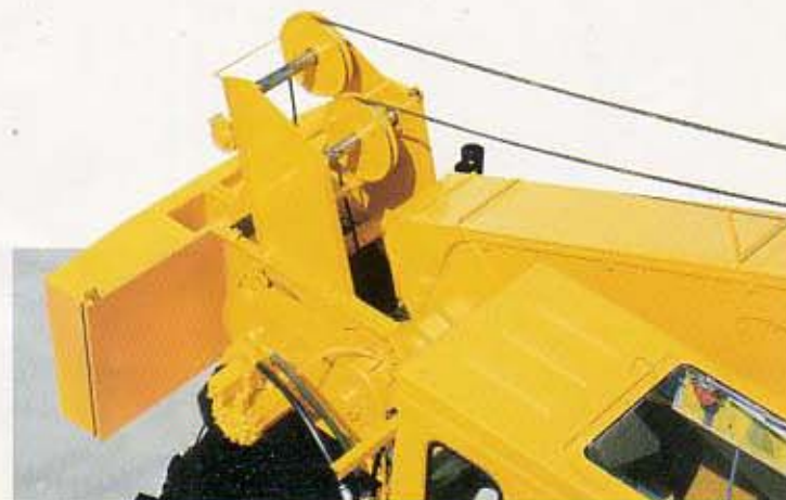
高・低速2段変速ができる強力ウインチ
