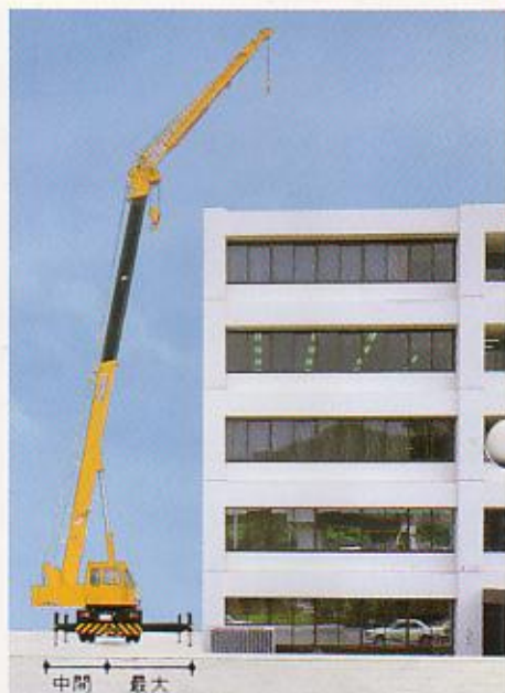
吊上能力を100%引き出す左右領域制御装置
