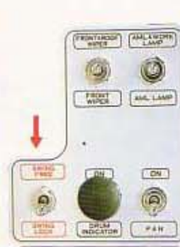
フリー・ロック切換式旋回機構
