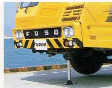
操作性のよい油圧式フロントジャッキ
