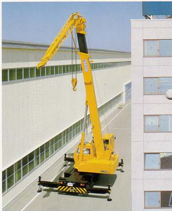
狭い現場も悠々ジブ張り出し装置付2段傾斜式ジブ
