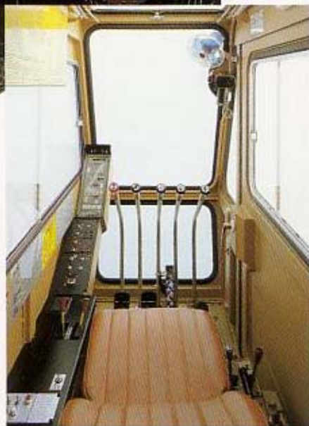
此照片示出TG-700E型的上车操纵室。仪表和操作装置的布置稍微不同于TG-500E型。
