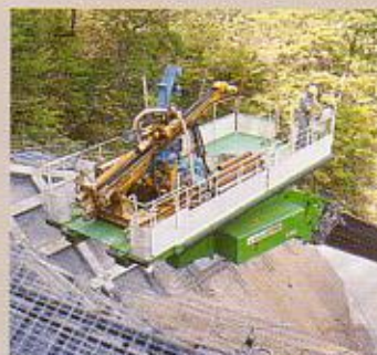
デッキ旋回により、どのような斜面にも的確にアプローチできます。
