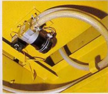
ビルジポンプ
