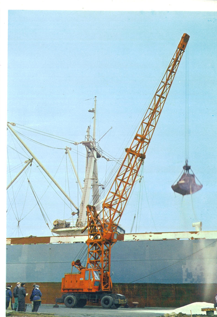
グラブバケットによる鉱石荷揚作業中のKM200/2T
