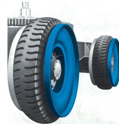
すべてのタイヤには、頑丈なタイヤ側板がついています。荷重によってタイヤが凹んでも、この側板が機械を支えますから、能率的な走行荷役も安心してできます。また傾斜による能力の低下や危険を、防止することができます。
