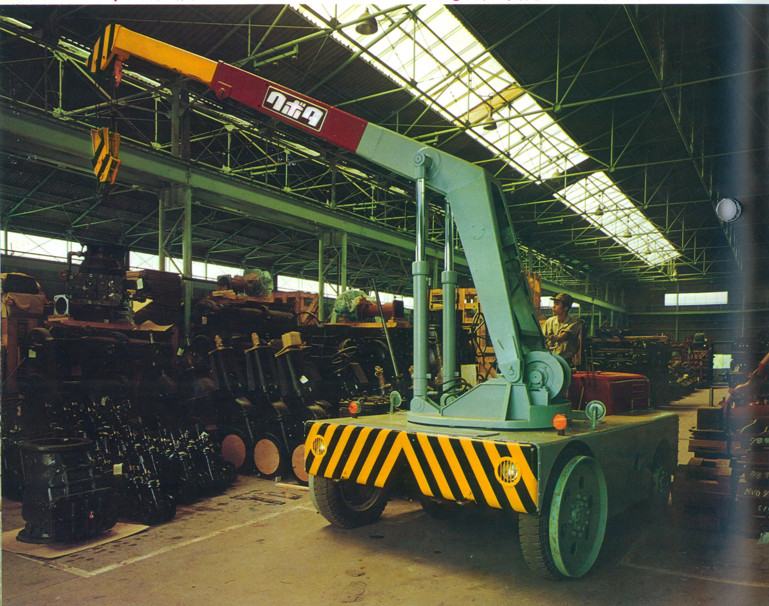
↓ 倉庫内で作業するKM-36モビルクレーン
