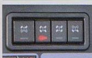
ステアリングモードは、ノーマル・リア・クラブ・クランプの4種類。切替えはスイッチひとつ。複雑な狭い現場内でのスムーズな移動ができます。
