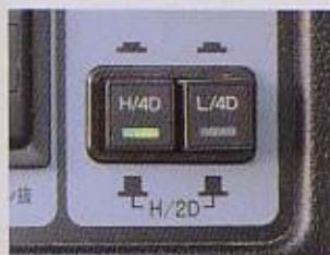
高速/低速と2駆/4駆を上手に組み合わせれば、路面状況に最も適した速度と力が得られます。特にリンクス160はクラッチパックの採用により、走行中のHi/Low切替えも可能になっています。
