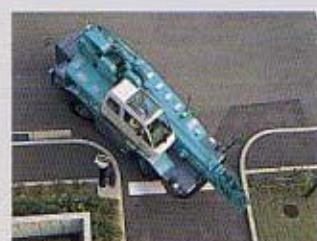
ステアリングモード切替えでクランプモード(4輪)を選択すれば、より小さな最小直角通路幅を得られます。走行姿勢の状態ではリンクス160で4.38m、リンクス100で3.52m幅を実現
