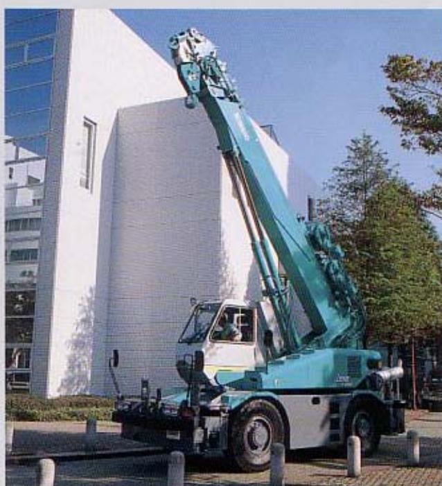
(右折時)。ブームを起立させてブームオーバーハング「ゼロ」走行にすれば、リンクス160で3.79m、リンクス100では何と3.26m幅の狭い直角通路にも進入可能です。
