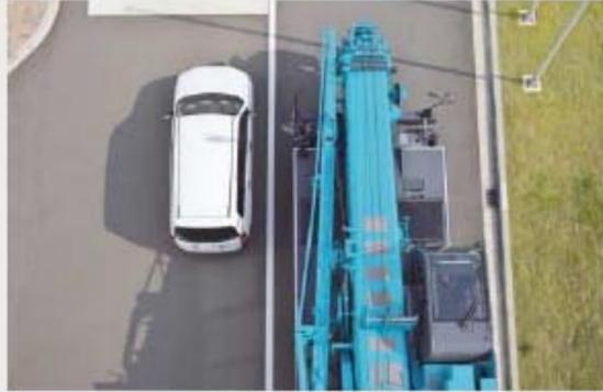
先端が傾斜したスラントブーム、前上方へ移動したアイポイントにより、左前方走行視界を拡大。さらに死角を減少し、車体の左側を通行する人や車両の安全を確認するために、左前方、左方カメラを装備し、左前直下の視界が大きく改善されています。2つのカメラの画像は、運転席前面左側のモニタに2分割画面で同時に表示されます。
