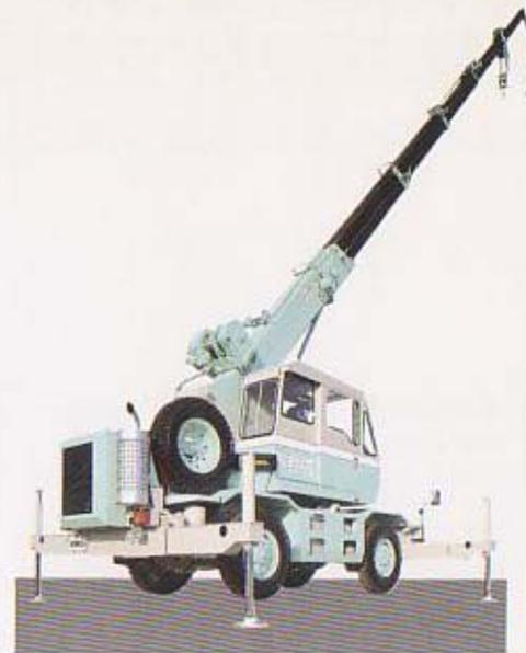
最長ブーム21.2m(ブーム+ジブ)で最小作業半径2.9m。後端旋回半径1.56m。狭い空間での旋回も容易。
