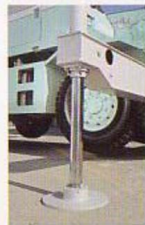
4.9t/7tトラッククレーンでは設置の困難な不整地や傾斜地でも、アウトリガの垂直ストロークが長いので、クレーンを容易に設置することができます。
