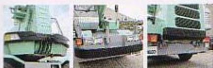
ドアと左サイドのミラーにより作業時の後方確認を容易に。また、リアアンダーミラーを追加し、運転席からの死角をなくしました。
