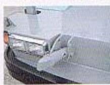
RK70M/RK70は荷物を吊った状態での走行が可能。現場で機器や資材の移動も行えます。また、ブームレストはワンタッチ格納式。キャリアのフロント上部をフラットにして吊り荷走行時の荷物置場としても活用可能。吊り荷の揺れを抑え、より安全に運搬できます。
