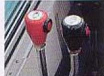
旋回ブレーキ、ブーム伸縮切替えが手を放したり、持ち替えたりしなくてもできるように、各レバーにスイッチを設置。
