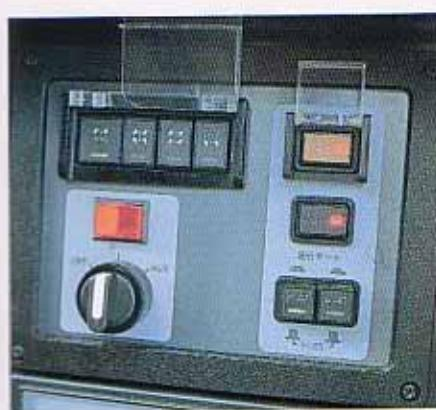
ステアリングモード、逆ステアリング、4WD・2WD切替えスイッチ。バークリングなどが「わかりやすくレイアウトされた操作パネル。プラスチックカバーで誤操作を防止。
