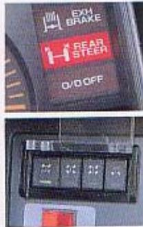
ステアリングを戻すとパネルのモニターランプが消灯。この状態でツーマル走行のスイッチを押せばリアステアリングは完全にロックされ、ノーマル走行に切替わります。
