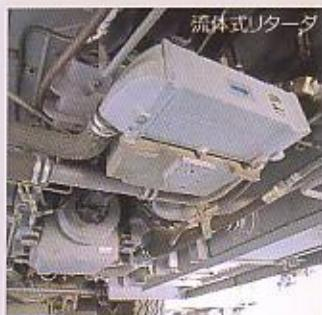
強力な制動力を発揮する油圧空気倍力装置付き4輪ディスクブレーキを採用。しかも補助ブレーキには、新たに5段階の調整が可能な流体式リターダを標準装備。長い下り坂でもフットブレーキの負担を軽くしながら安心して降坂できます。
