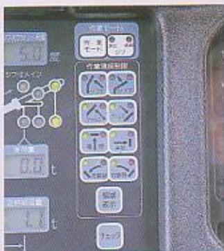
電線や生木、梁といった作業の妨げになるものが空中にある現場で、接触や衝突事故の防止に役立つ制限装置。旋回角度、ブームトップ高さ、作業半径、ブーム起伏角度、ジブ起伏角度(スカイチルト装備時)の限界をあらかじめ記憶させておけば、その領域を越えて作動させません。
