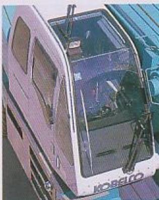
走行時にとくに問題となる左方視界を広げるため、ブーム起伏シリングを後方に配置、さらにブーム下面をオペレータの目線高さに設定し、肉眼で直接確認できる範囲を広くキープ。後方視界はカメラ映像によりマルチディスプレイで確認できます。また作業時にも、曲面グリーンガラスを採用したサッシレスウインドウによりブーム先端まですっきり視認可能。雨天時にも配慮してワイパーのブレード長さを延長し、拭き取り面積を拡大しました。
