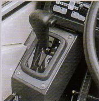
さらに熟成した電子制御フルオートマチックトランスミッション。コベルコが業界で初めてクレーン用に開発。すべてコンピュータで制御されているので、機能は乗用車なみ。アクセルとブレーキのペダル操作だけで快適な走行が可能。しかも、バンサーではDレンジの3速をさらにパワーアップ。一般道路も軽快に走れ、ちょっとした坂道もシフトチェンジなしで登れる。ストップ&ゴーを繰り返す都市の道路もイライラなく走行できる。
