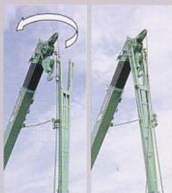
パワーツィスト採用のくスカイテルト》。〔オプション〕チルトジブのツイストシステムは、張出にスペースをとらないので、狭い現場でも余裕をもって行える。しかも、構造がとてシンプルなためキャブへの乗降回数も少なく済み、その分作業時間を短縮できるといった優れた特徴を持っている。パンサーでは、そのチルトジブのツイスト作業を自動化したパワーツィスト採用のくスカイテルト》を装備。格納・張出姿勢への連結をさらに簡単に行えるようにした。
