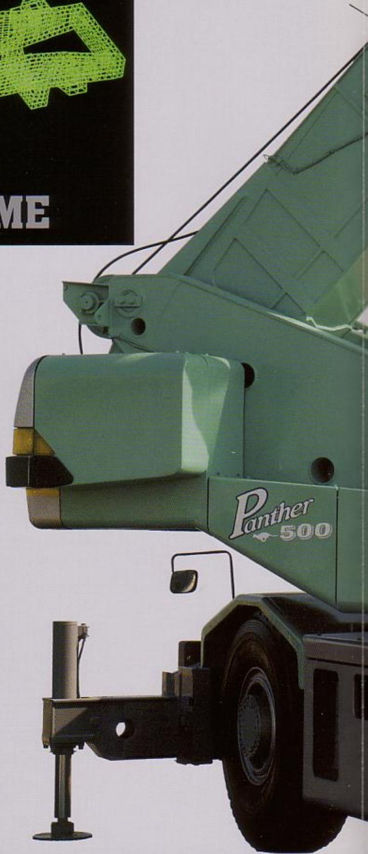
た、ブームフットピンをブーム上に配置し、起伏シリンダをブームに平行に取りつけてブーム全体を下げることも成功。さらに、旋回ベアリングの取り付け座面を下げ、旋回時にキャブ
