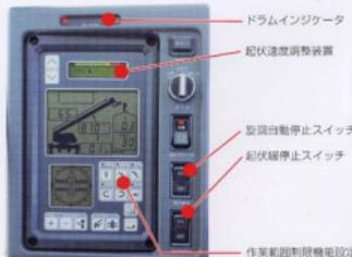
起伏角度、ブーム長、作業半径、アウトリガ張出幅の作業状況を1つの画面に液晶表示。安全な作業を実現します。
