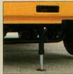
●全周同一の吊り上げ性能を発揮、油圧式フロントジャッキ
