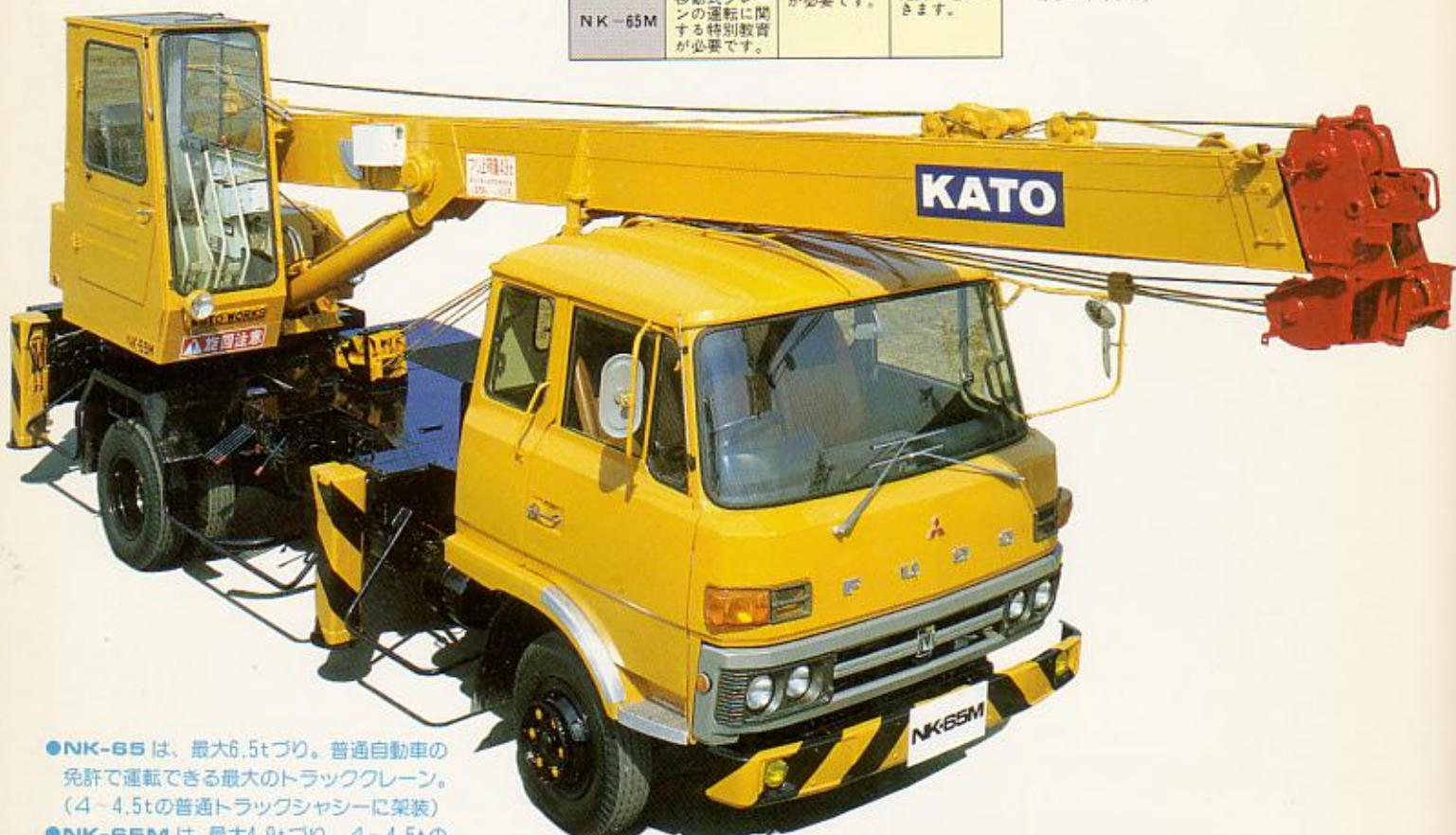
●NK-65は、最大6.5tづり。普通自動車の免許で運転できる最大のトラッククレーン。(4~4.5tの普通トラックシャシーに架装)
