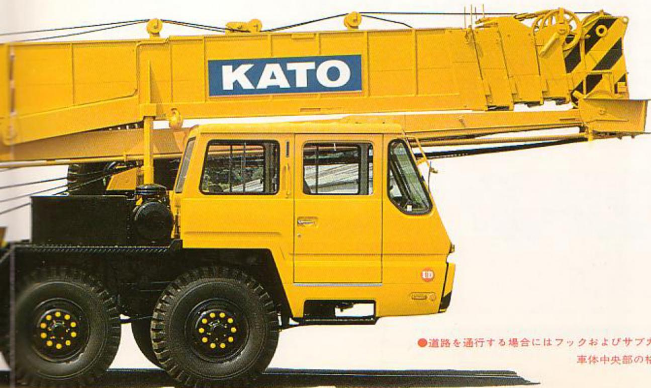
●道路を通行する場合にはフックおよびサブカウンタウエイトを車体中央部の格納器に固定して下さい。
