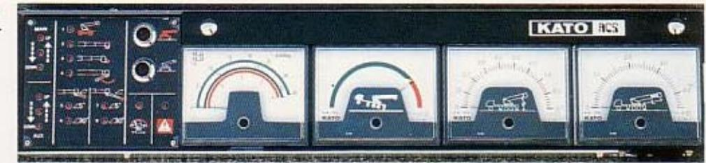
● 事故を未然に防止…従来オペレータの経験、目測、カンによって行なわれておられたクレーン作業が、ACS®コンピュータなどの装備により合理的に、しかも転倒事故や折損事故を未然に防止しながら安全かつ能率的にできます。
