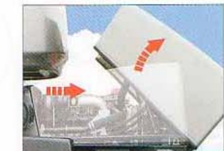
●保守点検がスムーズ、開閉が簡単なスライドバルブ式エンジンカバー
