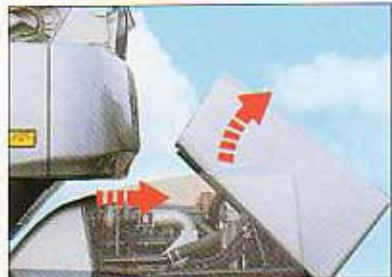
●保守点検がスムーズ、開閉が簡単なスライド・バルブ式エンジンカバー
