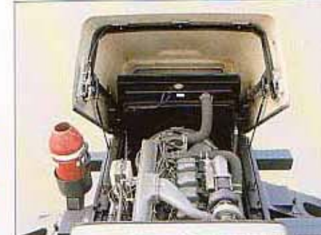
●低燃費・低騒音を両立、強力な320PSインタークーラー付ターボエンジン
