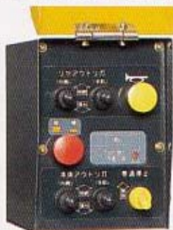
アウトリガ操作用スイッチボックス
