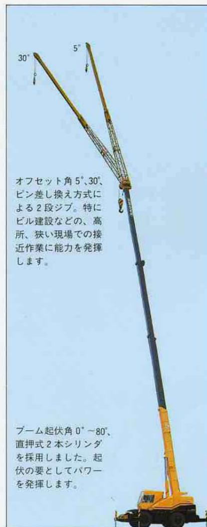
オフセット角5°、30°、ピン差し換え方式による2段ジブ。特にビル建設などの、高所、狭い現場での接近作業に能力を発揮します。
