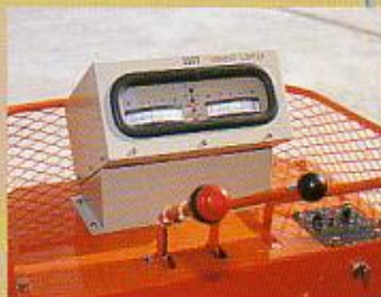
運転席(実作業中継・実荷重表示計)
