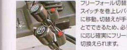
フリーフォール切替えスイッチを巻上レバーに移動。切替えが手もとでできるため、必要に応じ確実にフリーに切替えられます。
