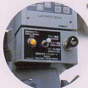
精度が求められるつり荷作業では旋回レバーを中立ブレーキに、連続的に旋回操作を行うバケット作業時などは中立フリーに。作業にあわせて選択できます。また、旋回スピードの上昇を抑えて荷振れを防ぐ低速旋回制御機能も設定。中立ブレーキモードでは自動的に働きます。
