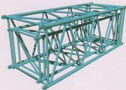
中間ブームは対角支柱を片方だけに取付けて、内部に中間タワージブを収納できるネ스팅ブームとしました。輸送車両の数を減らすことができ、さらに保管場所の省スペースにも貢献します。
