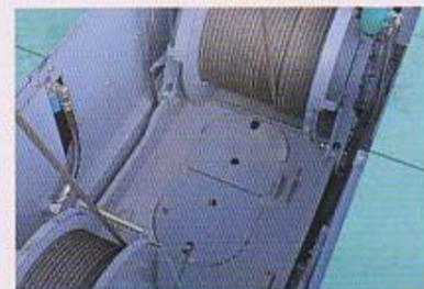
コンパクトな湿式ウインチとサイドエンジンレイアウトの採用により、オプションのサードドラムは主・補巻同一サイズの大容量。基礎・土木作業にもきっちり対応できます。
