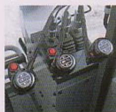
フリーフォール切替えスイッチを巻上げレバーに装備して、操作をしやすい。フットブレーキをいっばいに踏み込んだ状態でなければ切替えできないインターロック機能付きで、つり荷落下の原因となる誤操作を防ぎます。
