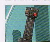
■旋回操作は反力感知機能付き油圧パイロット方式
