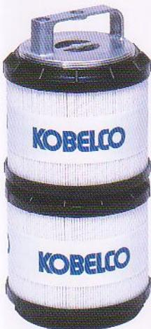
鋼線補強のガラス繊維ろ材により、高強度でダスト捕獲能力もすぐれた新型作動油フィルタ・スーパーファインフィルタを採用。フィルタ交換時間は一挙に4倍に延長。建設機械用としては初めての分割構造式で、交換はろ材のみでOK。交換インターバルの延長と廃却部の減少により環境負荷は大幅に低減しました。
