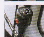
■操作レバーから手を離さずにON/OFFできるグリップ一体型の微速制御スイッチ
