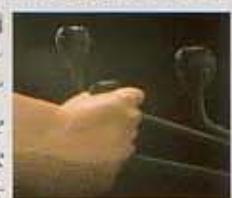
旋回操作にも反力感知システムを採用。応答性の良いダイレクトコントロール式の旋回操作に、反力感知システムをプラス。操作フーリングを一段と向上させました。旋回モータの負荷圧をコントロールバルブに導いて、スプールの動きに抵抗を与え、ロッド、リンクを介して旋回レバーに反力を伝えます。立ち上りの負荷の大小がオペレーターの手に感じられ、重旋回も軽旋回も感觉通りの操作が行えます。
